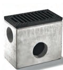
Einlaufkasten: 35 x 20 x 30 cm, mit Gussrost, Schlammeimer, Reinigungskelle und KG-Anschluss-Formteil.
